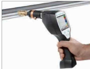
Schneller Einbau mit Messkammer und Schnellkupplung
