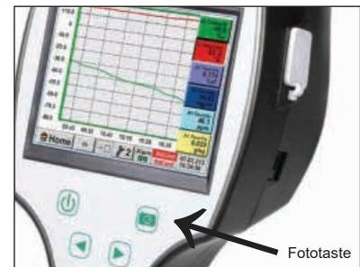
Fototaste speichert aktuellen Bildschirm als Bilddatei. Keine zusätzliche Software notwendig.
